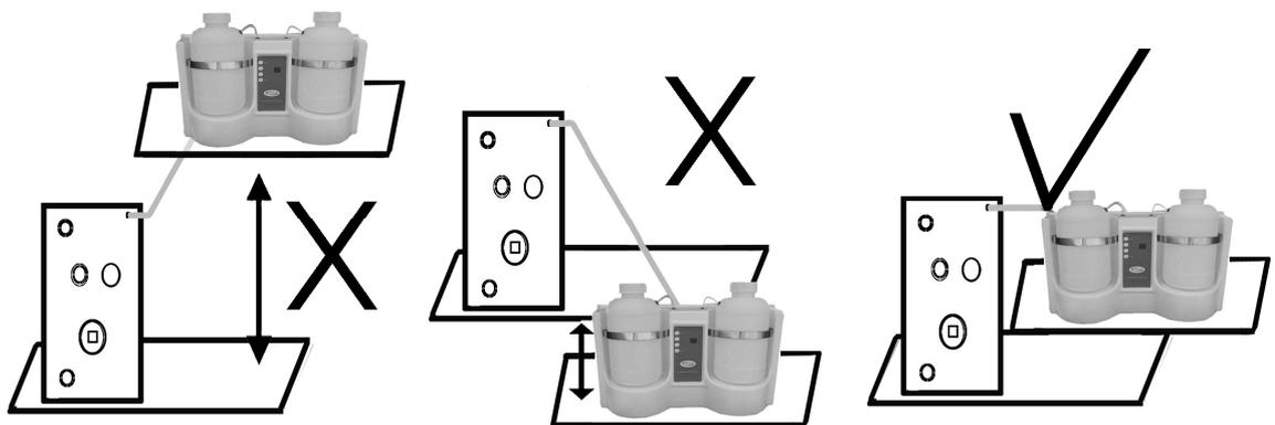
建议将香芬机挂在墙上。其背板上备有两个安装挂口，使用者根据下图所示距离确定挂孔位置。 图示 4
